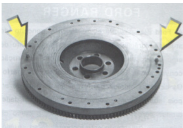
Volante com pino guia e com desgaste
